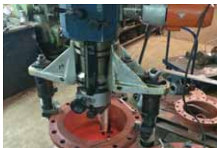
Tokarenje sjedišta nepovratne zaklopke
