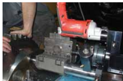
Tokarenje provrta na spojki turbina - generator
